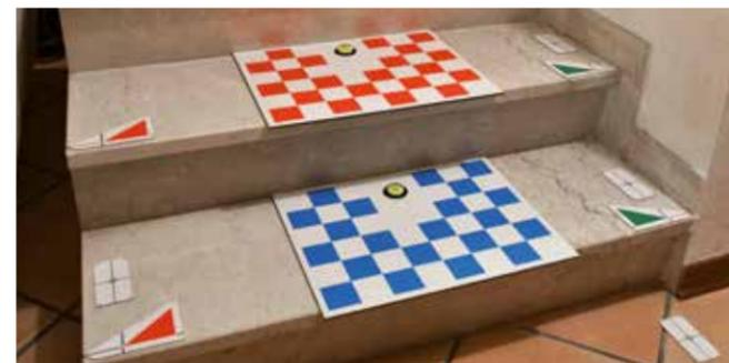
> Stairtracker, lo strumento esclusivo Stannah per prendere le misure precise della scala, necessarie per una perfetta progettazione.
